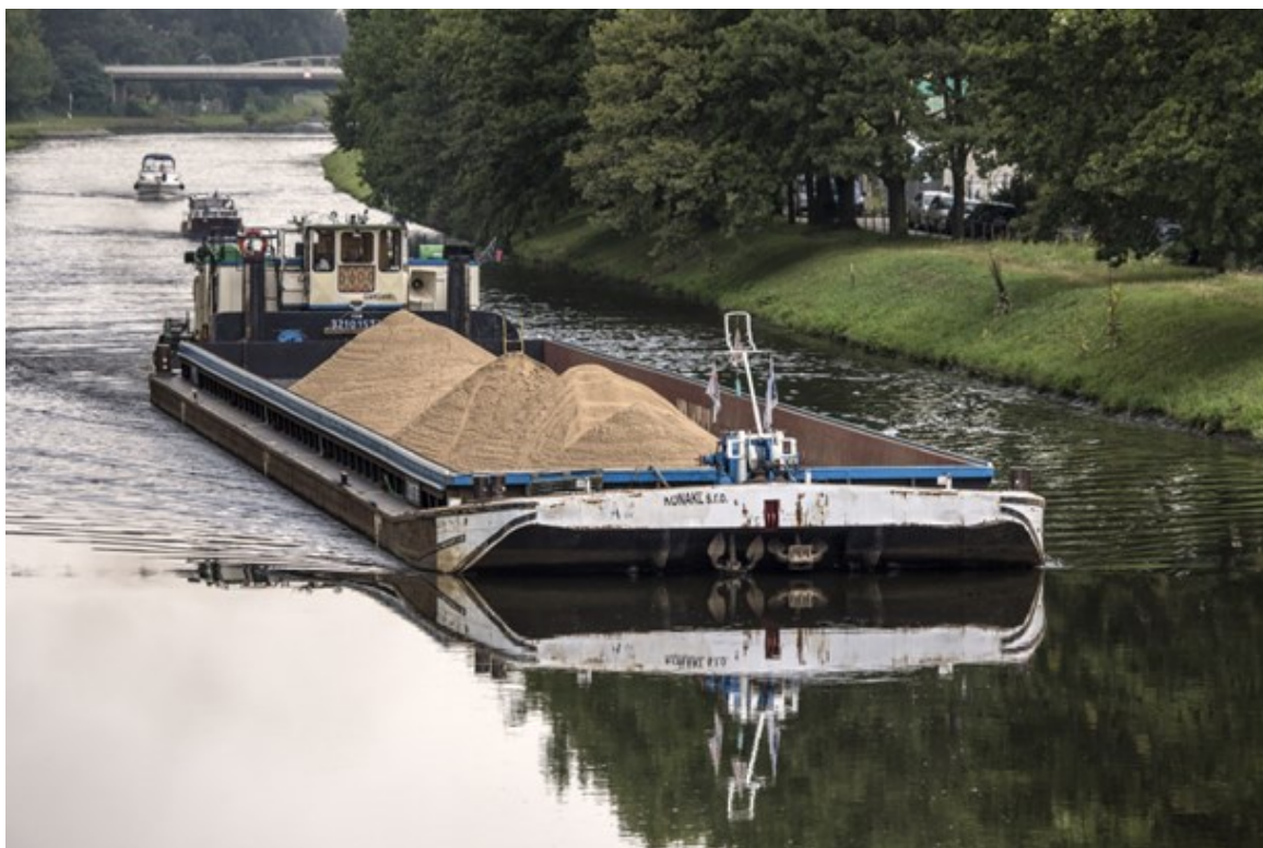
Obr. 5: Přeprava kameniva do betonárky na Rohanském ostrově (zdroj: TBG Metrostav)
