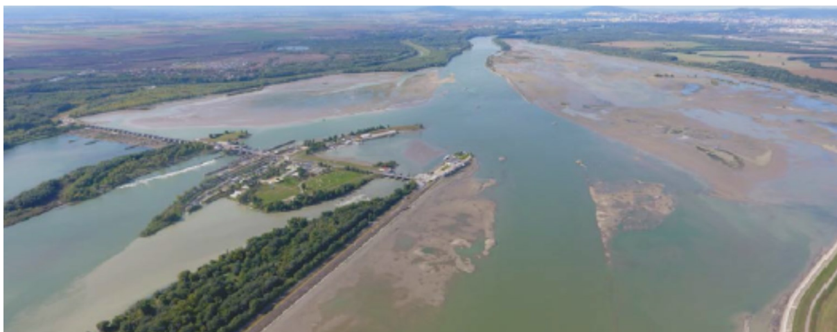
Obr. 5 Sedimenty v Zdrži Hrušov pri zníženej hladine 30.09.2012. Zdroj - Diplomová práca Ing. Pavla Virága ml.
