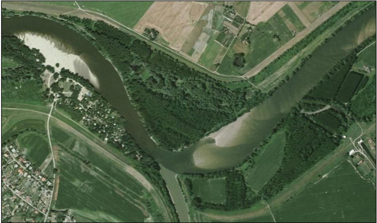
Obr. 15 Váh pri vyústení preložky Nitry. Rozsiahla sedimentácia. Foto autor
